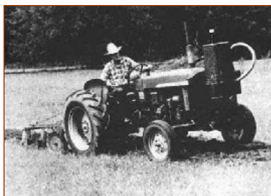
Figura 1.1 – Gasógeno incorporado a un tractor. Combustible: corteza de pino, residuo de aserradero
